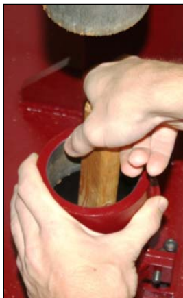
(d) Scarifying Surface
