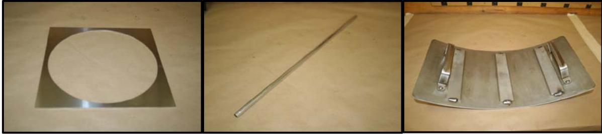
a) *Strike-off Template*                      b) *Strike-off Rod*                      c) *Sweep Test Compactor*
