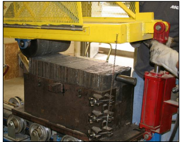
(d) LAC Ready for Compaction
