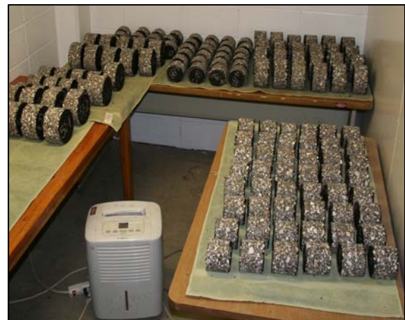
(d) Cores in Drying Area
