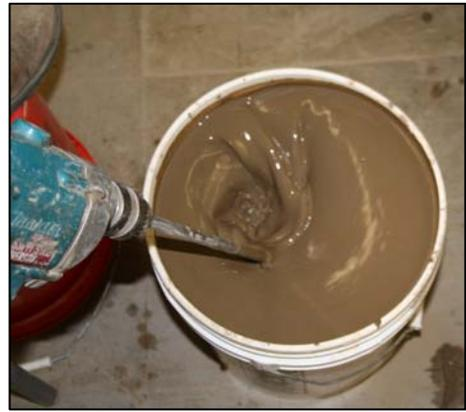
(d) *Agitation of Soil Slurry*
